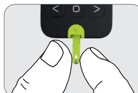
Sortir une bandelette de test du flacon et refermer le capuchon du flacon. Insérer la bandelette dans l'orifice d'introduction du lecteur. Le lecteur se met automatiquement sous tension.
